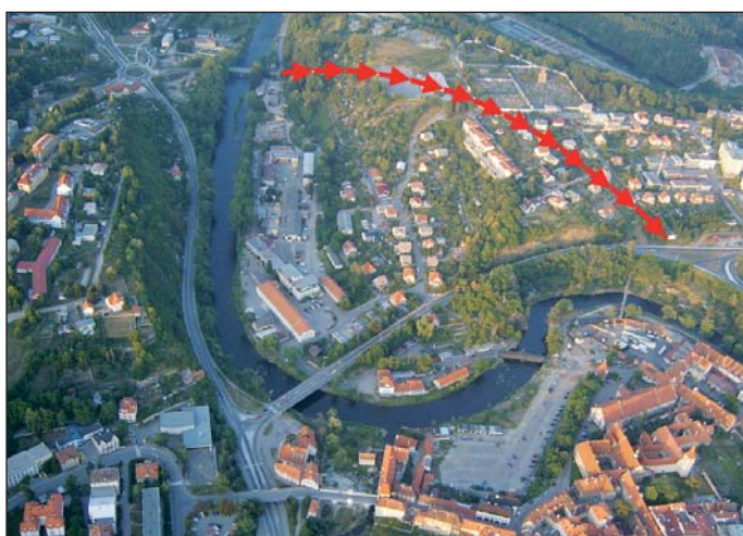
Obr. 1 Letecký snímek Českého Krumlova s vyznačením trasy tunelu Fig. 1 Aerial photo of Český Krumlov with the tunnel route layout
