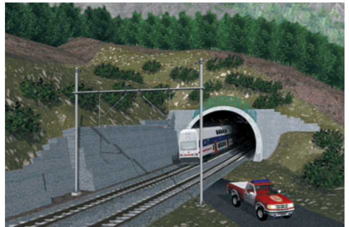
Obr. 9 Výjezdový portál tunelu Malá Huba – zajištění zářezy gabionovou zdí Fig. 9 The exit portal of the Malá Huba tunnel – stabilisation of the cut by a gabion wall
